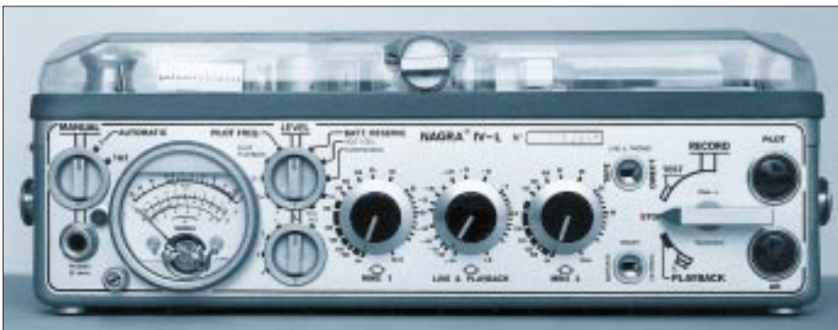
Kudelski, NAGRA IV und 4.2, Modulbauweise, Standardgerät bei Rundfunkanstalten in aller Welt seit 1969
