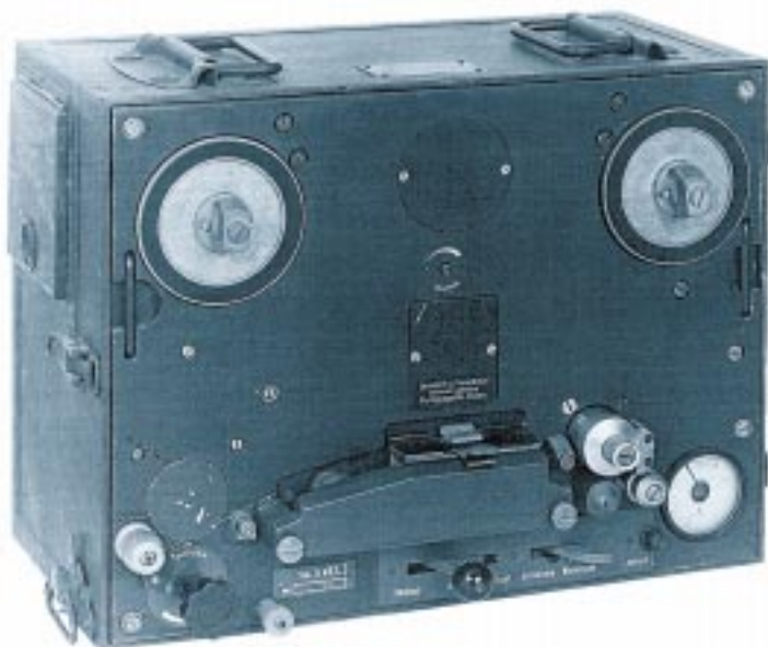
Laufwerkteil Tonschreiber „Bertha“, Ausführung „Ton S. b1“, 1943, ohne „Dehnerkopf“
